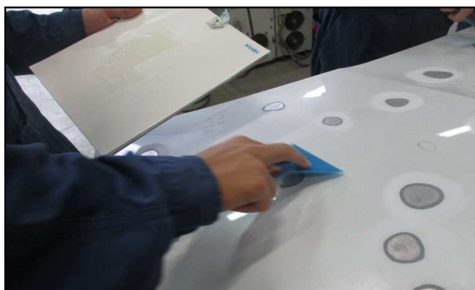
キズや凹みを埋めるためのパテ入れ作業
