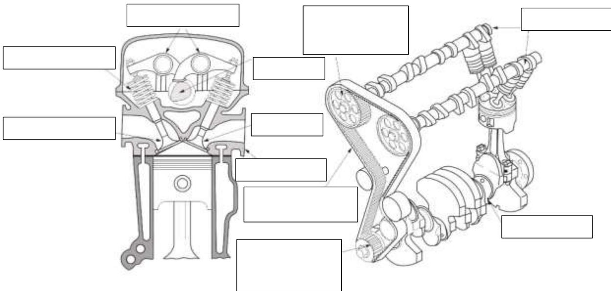
(34) 弁の開閉機構は、弁の配置によって側弁式と頭弁式とに分類されるが、頭弁式について以下の空欄に対応する語句（アルファベット）を記入しなさい。
