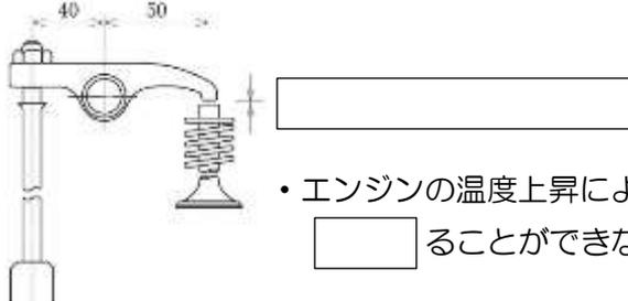
• エンジンの温度上昇によりバルブが  し、バルブが確実に  ることができないため、ガス  を起こす。
